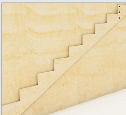
1 Fijar limones a la estructura.
